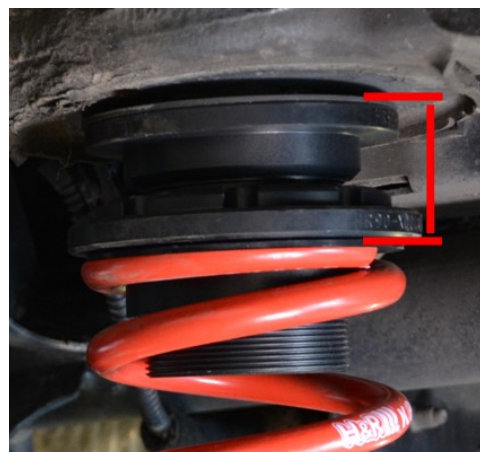
Abb. 5: Einstellmaß HA (Abb. ähnlich) Fig. 5: RA adjustment dimension (Fig. may vary)
