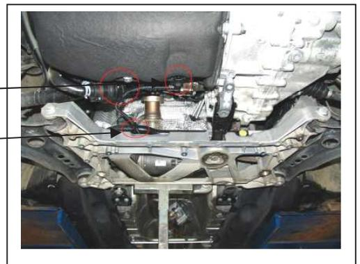
05. Drehmomentstütze Getriebe lösen (2 x SW16).
