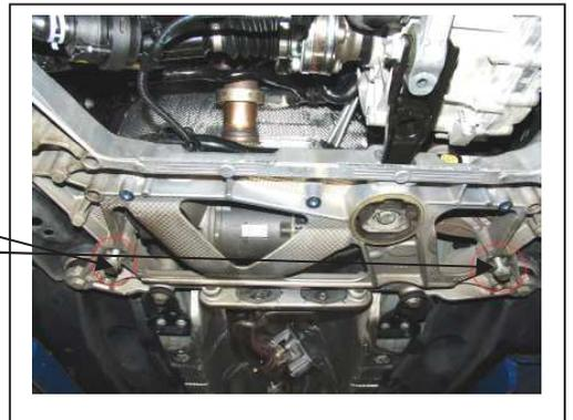
08. Stabilisator vom Achsträger lösen (4 x SW13)
