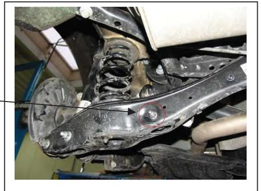
02. Halter für Niveaugeber am Querlenker links demontieren
