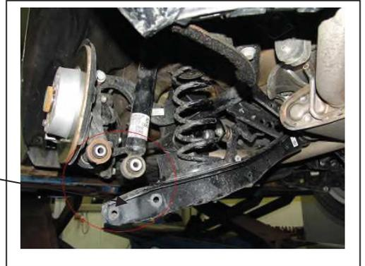
04. Auspuffenschalldämpfer links und rechts lösen (2x SW13) und mit geeignetem Mittel abstützen, Auspuffanlage etwa 5cm absenken.
