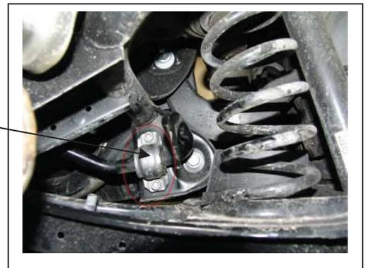
06. Koppelstangen am Anti-Roll-Kit vom Serienteil in gleicher Anbaulage umbauen!
